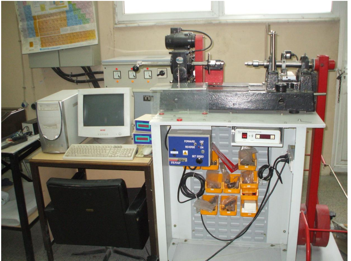
Şəkil 24. SM 21 (Advanced torsion testing machine) torqmetr cihazı
