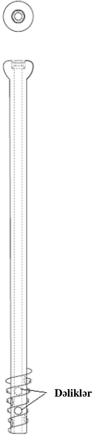
Şəkil 18. Dizayn edilən 7 mm kanallı vint
