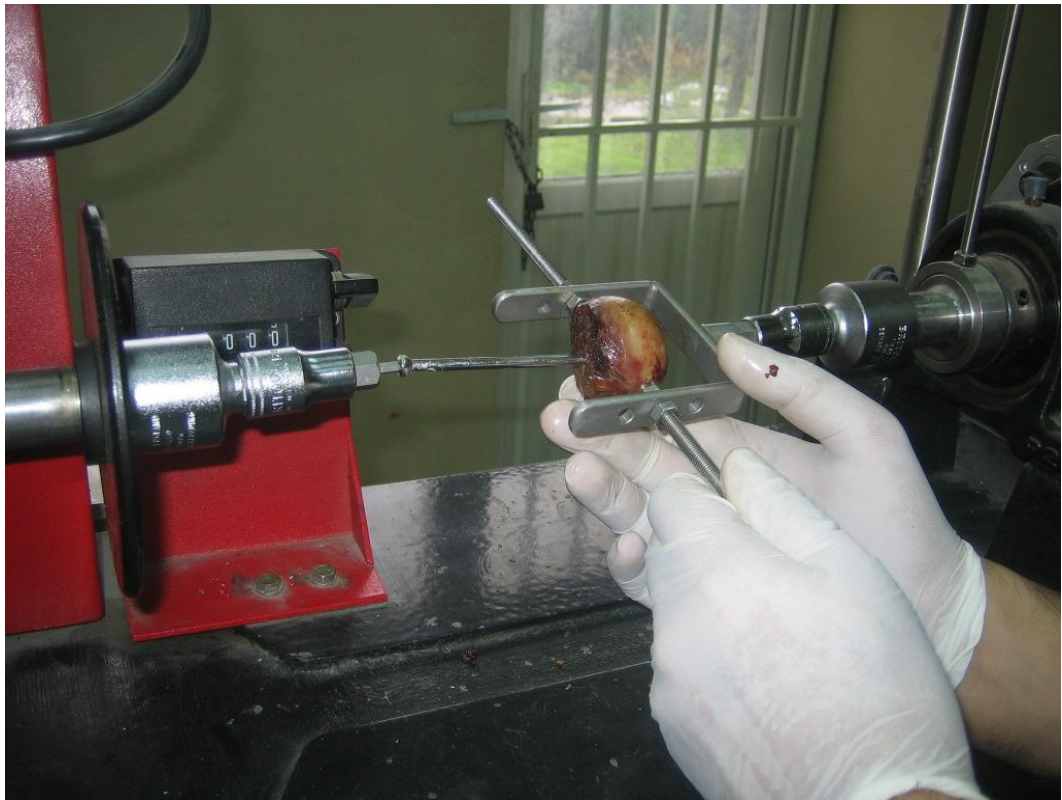
Şəkil 27. SM 21 torqmetr cihazında qüvvət ölçümləri
